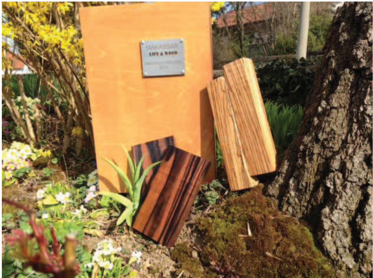
vorne links: Makassar 1 für Holzbläser (250x50x50mm) vorne rechts: Makassar 2 für Blechbläser (200x110x22mm) hinten: Makassar für Percussion (2 Mal: 450x300x300mm)
